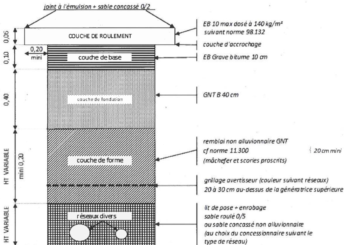
Un géotextile adapté est à mettre en place en cas de risque de pollution par des éléments fins, selon la norme en vigueur
